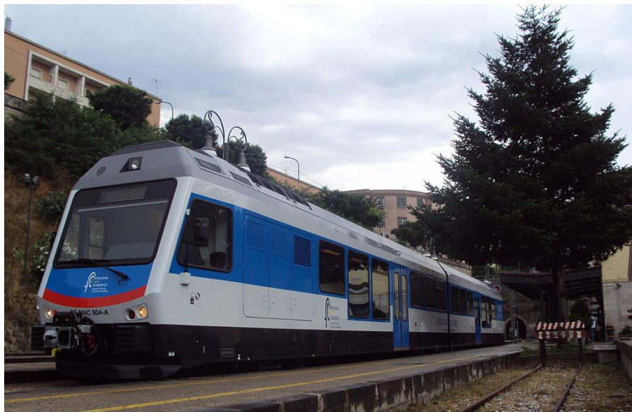
Figura 19 - L'automotrice DE M4c.500 della metropolitana di superficie
